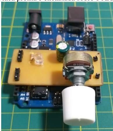
Figura 4: Placa pronta e encaixada sobre o Arduino UNO.
