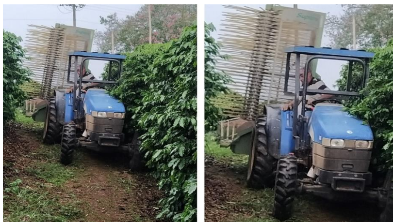
Figura 2 – Conjunto tratorizado, trator New Holland e derriçadora VN modelo Suprema utilizados no estudo entre as ruas na lavoura cafeeira.
