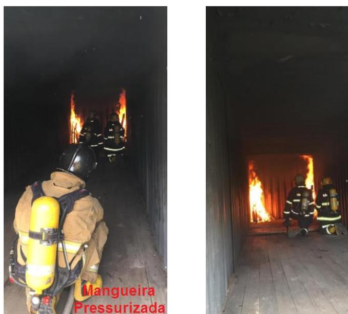
Foram testados três trajes (Calça e Capa) de fabricações distintas e com pesos e características diferentes, por 15 minutos de incêndio.
