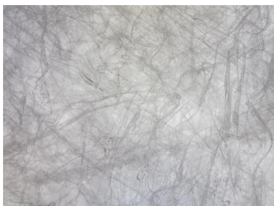
Figura 7 – Meio filtrante das máscaras PPF2.
