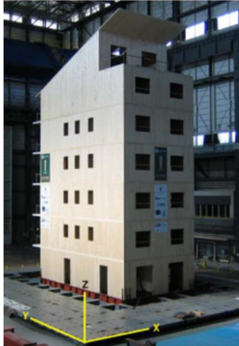
Figura 2: Edifício em CLT em escala real
