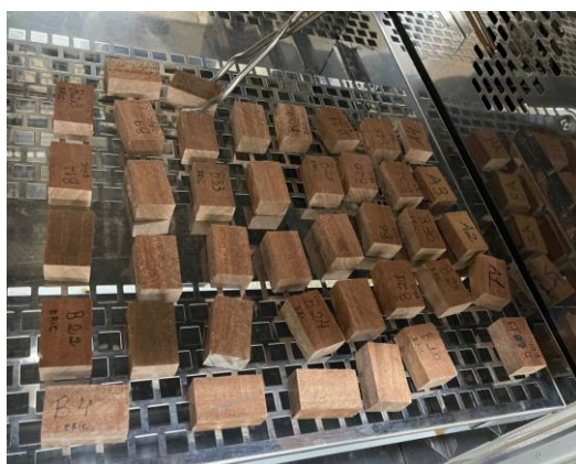
Figura 4 - Corpos de prova de Cariniana micrantha Ducke em estufa de secagem.
