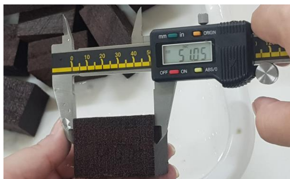
Figura 6 - Determinação das medidas dos corpos de prova pelo paquímetro.
