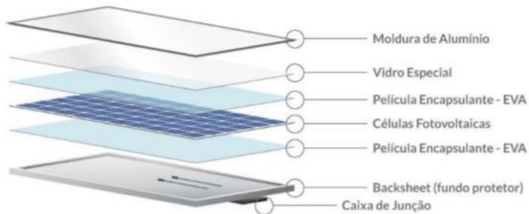
Figura 2: Estrutura módulo fotovoltaico
