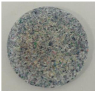
Figura 5 – Pastilha prensada de placa de circuito impresso
