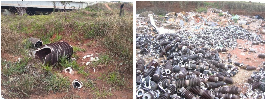
Figura 2 – Descarte na natureza de isoladores elétricos de porcelana substituídos.
